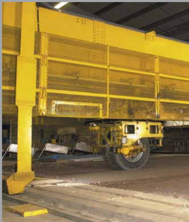
2000 – Badania w pełnej skali, przeprowadzone w Laboratorium Badań Transportowych (TRL) w Wielkiej Brytanii, porównują efektywność georusztu Tensar z alternatywnymi rodzajami geosiatki.
