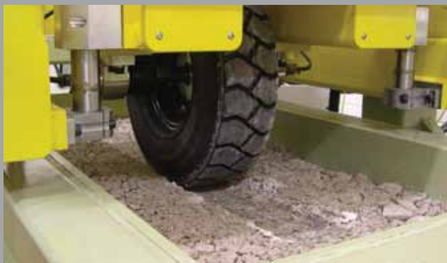
2007 Centrum Technologiczne Tensar – Firmowy ośrodek testowy pozwala na badanie georusztów Tensar, kruszyw i gruntów podłoża w testach pod obciążeniem ruchem.
