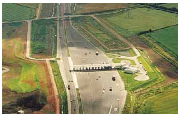
Stacja poboru opłat przed mostem autostradowym Second Severn Crossing wybudowana na platformie LTP z georusztów Tensar (Wielka Brytania).
