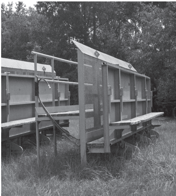
Przykład ramy hydraulicznej stosowanej jako stojak do wypełniania materaca.
