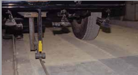
1996 – Mechanizmem skrępowania boczno kruszywa prowadzi do znacznej redukcji głębokości koleiny.
